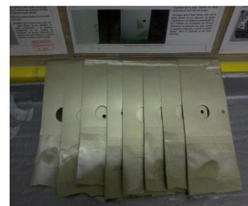
Estos color checks fueron aplicados sin usar un manómetro, con la misma pintura y el mismo equipo de aplicación y el mismo día solo que con diferente operario, el cual calibró a **oído y tacto la presión de aire**. Como pueden ver los resultados fueron muy diferentes. Básicamente un color a **baja presión** tiende a oscurecerse e intensificarse y a **alta presión** tiende a aclararse y hacerse grisáceo.
